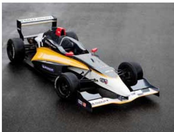
La monocoque en carbone et nid d'abeille est la première à avoir reçu l'homologation FIA F3 2011. Étudiée en soufflerie et en CFD (Computational Fluid Dynamics), l'aérodynamique se caractérise par une charge plus importante que sa devancière, permettant un passage en courbe plus rapide.
